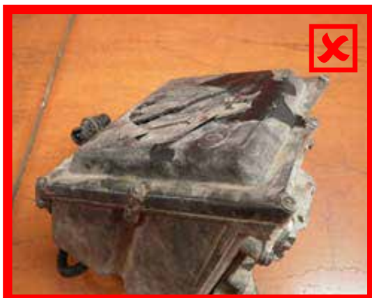
Poškození víka → nevyhovující
