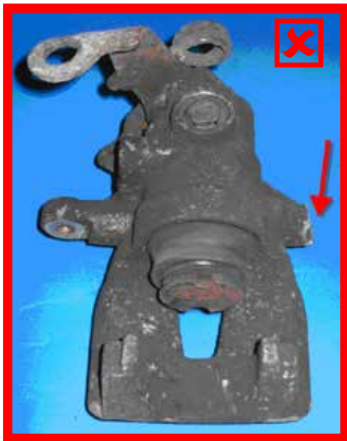
Poškození tělesa/krytu. Částečně ulomeno
