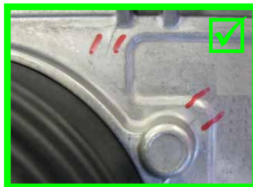
Výstupky na tělese po lití (žádné trhliny) → vyhovující
