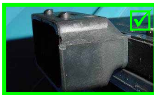
Konektor lehce poškozen max. 2 mm
